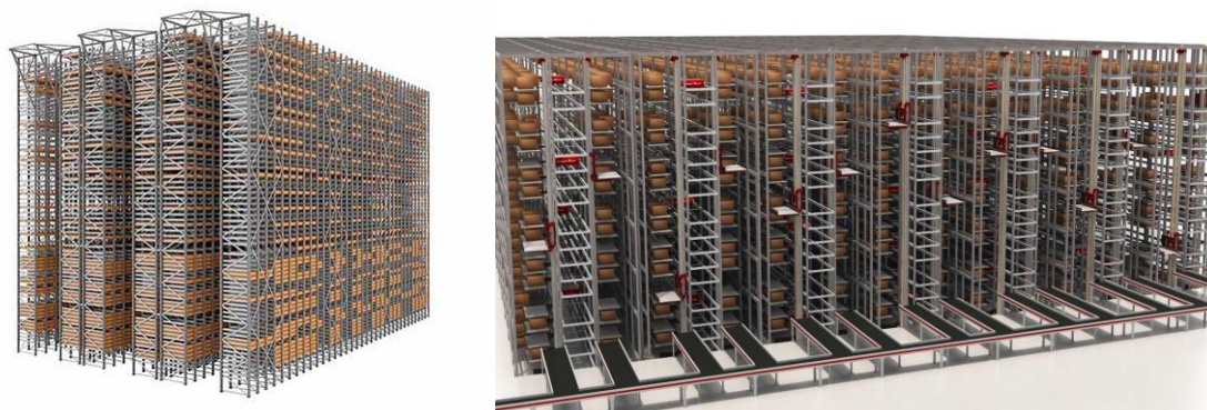
Figure 6-6 : Vue d'un mini-load à gauche et un shuttle à droite
